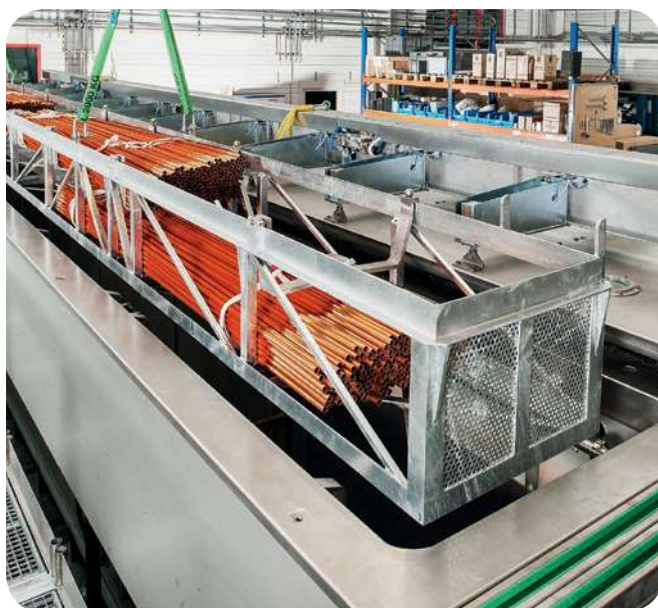
Čištění dlouhých měděných trubek
