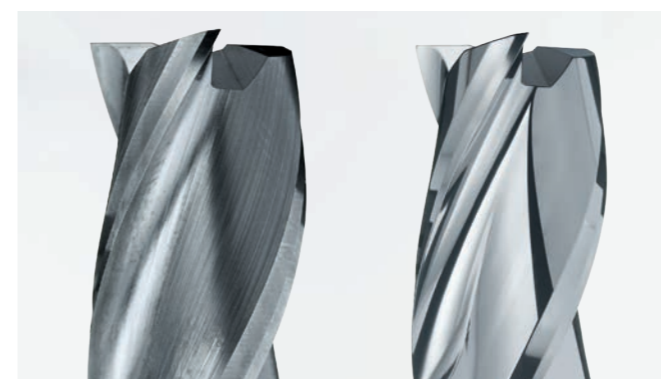
Řezný nástroj před a po zpracování
