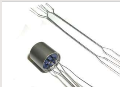
Jemné svařování elektronických součástek, např. termočlánků
