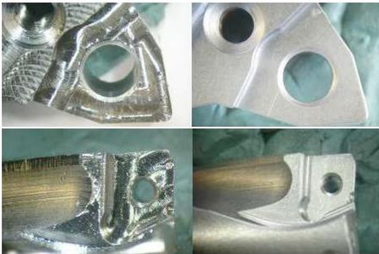
Těla fréz před (vlevo) a po opracování (vpravo) strojem SF
