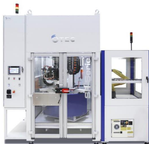
Proudový stroj pro finální úpravu povrchů SF 3 Automation
