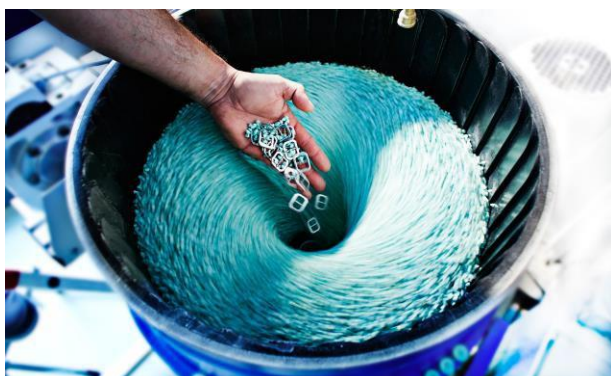
Intenzivní opracování různými odstředivými silami
