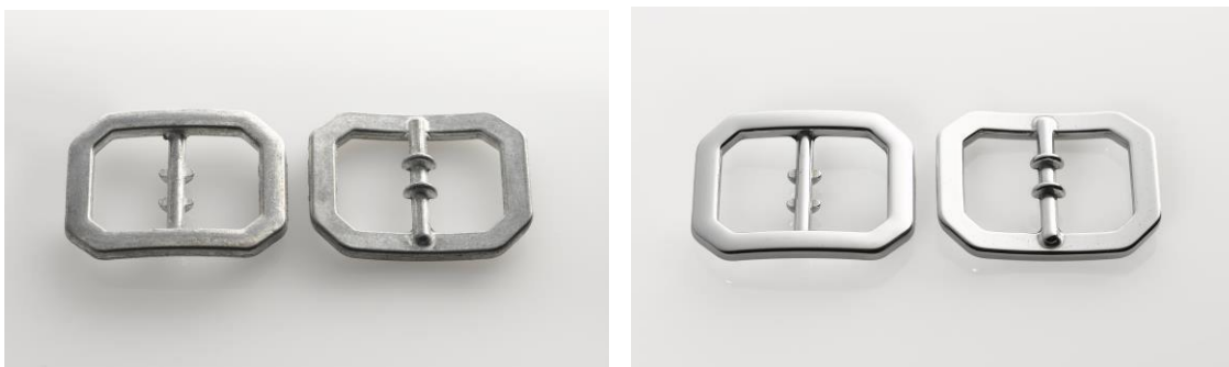
Opasková přezka před a po zpracování v diskovém odstředivém zařízení
