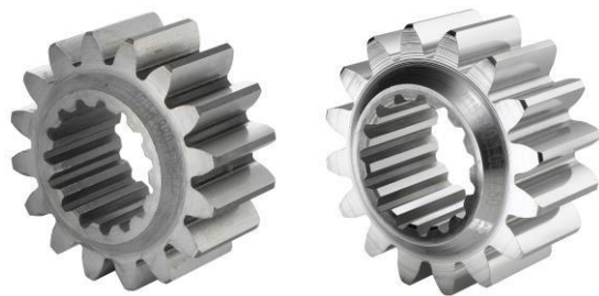
Ozubená kola pro motoristický sport před úpravou a po ní.
