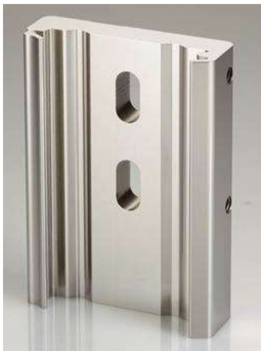
Střížník vyhlazený a vyleštěný pomocí procesu OTEK
