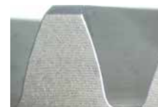
Stěna zubu po finální úpravě
